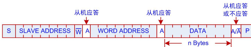
图 4.5 主机向从机发送数据示意图
