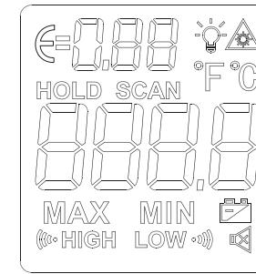
设定时“”闪烁，单击“▼”或“▲”循环选择静音开/关。静音开时为“HIGH LOW”，测量温度超过高温限值或低温限值时蜂鸣器无声音；静音关时为“”，测量温度超过高温限值或低温限值时蜂鸣器有间隔声音。
