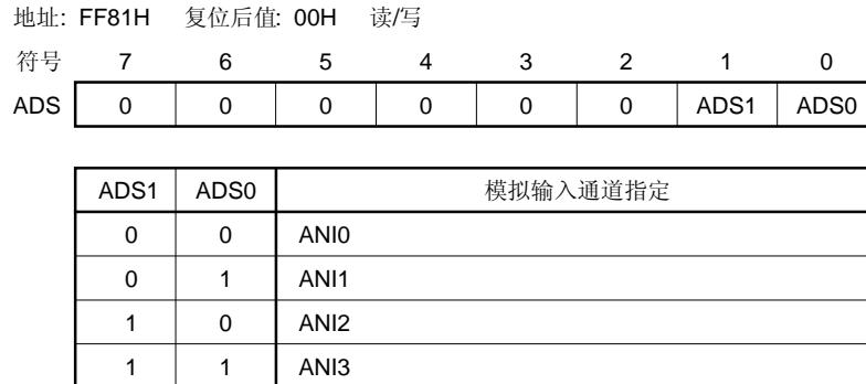
图 9-5. 模拟输入通道选择寄存器 (ADS)的格式
