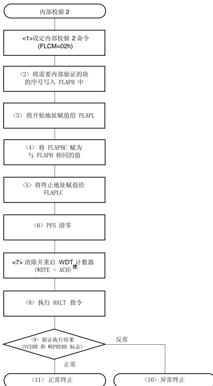
图 16-27. 自编程模式下内部校验 2 操作示例
