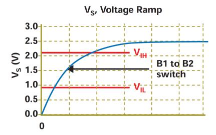
Figure 14. V<sub>S</sub> Voltage Ramp
