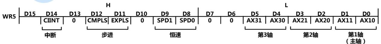
D1, 0 指定运行插补驱动的第一轴(主轴)，下图所示轴编码。
