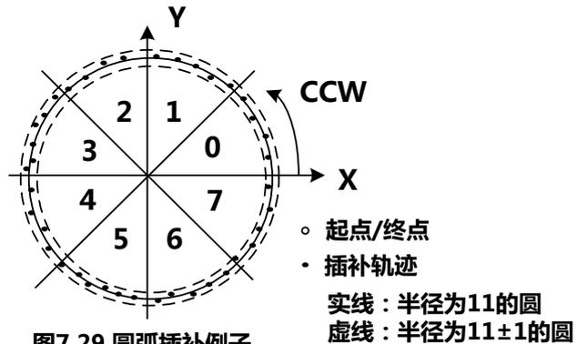
图7.29 圆弧插补例子
