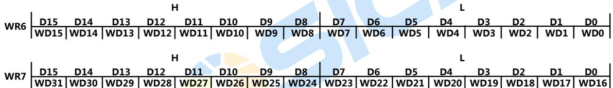
数据寄存器在操作与数据相关的命令时使用。在将命令字写入WR0之前，应将数据写入WR6和WR7，WR6存低字节，WR7存储高字节数据。
