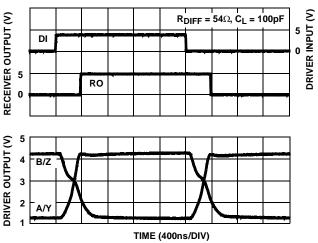
FIGURE 19. DRIVER AND RECEIVER WAVEFORMS, (ISL3153E, ISL3155E)
