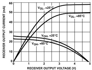
FIGURE 21. RECEIVER OUTPUT CURRENT vs RECEIVER
