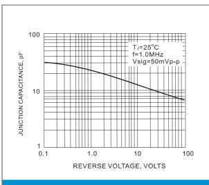
Fig.5 TYPICAL JUNCTION CAPACITANCE
