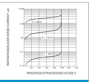
Fig.4-TYPICAL REVERSE CHARACTERISTIC
