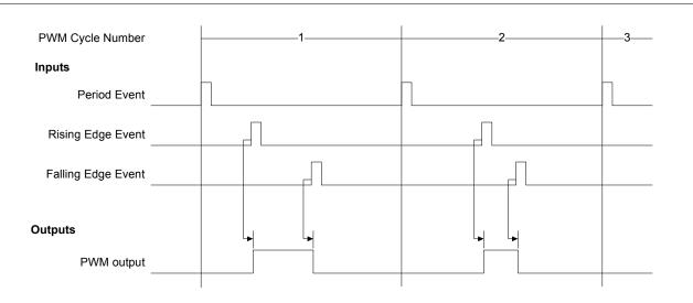
FIGURE 24-2: BASIC PWM WAVEFORM GENERATION
