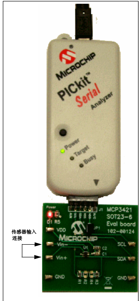
图 7-2: MCP3421 评估板与 PICkit™ 串行分析器配合使用的设置
