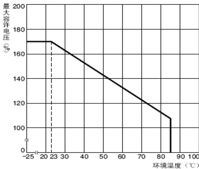
注. 最大容许电压指的是继电器线圈电压容许变动范围的最大值。
