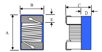
A max. : 3.60 mm B max.: 2.90 mm C max.: 2.50 mm D ref. : 1.10 mm E:  $0.5 \pm 0.1 \text{ mm}$
