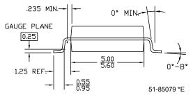
Figure 21. 28-Pin (300-Mil) SOIC
