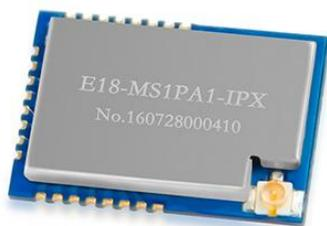
E18-MS1PA1-IPX 是成都亿佰特设计生产的一款体积小小的 2.4GHz 无线模块，发射功率 100mW，贴片型（引脚间距 1.27mm），收发一体；模块自带 IPEX 射频接口。该模块目前已经稳定量产，并适用于多种应用场景（尤其智能家居）。
