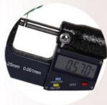
真正4N级别无氧铜导体符合23AWG=0.570mm(非0.56mm)
