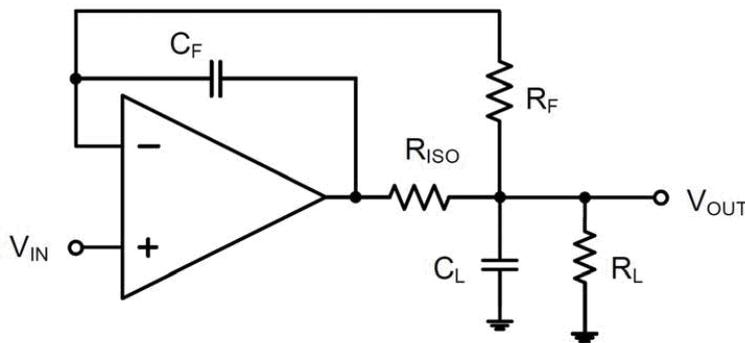
图 2, 直接驱动高电容，保证 DC 精度
