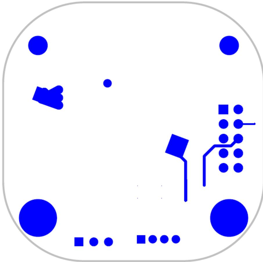
图 7-3 参考设计 PCB Bottom 层
