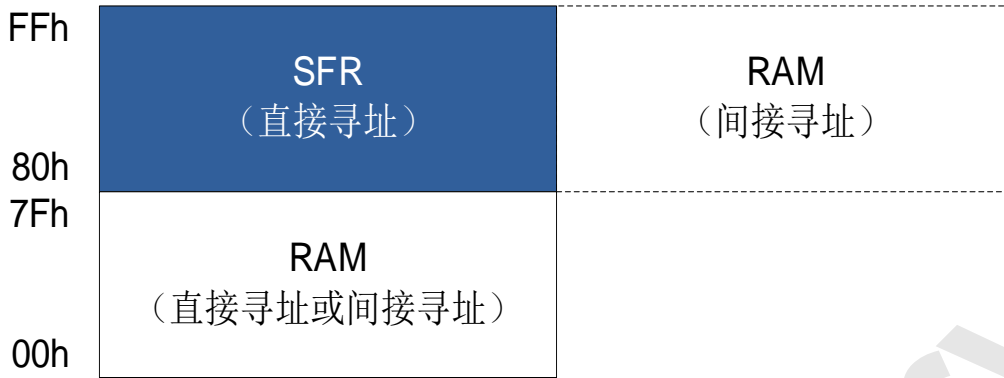
内部 256 bytes RAM 结构图
