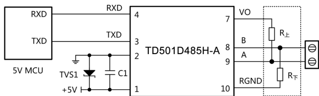
图 1.MCU 5V供电应用电路
