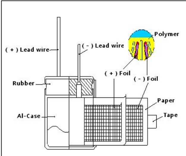
导针:固体镀锡铜包钢线
