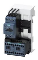
FUSELESS MOTOR STARTER REVERSING OPERATION 600V AC SZ S00 0.11-0.16A 220/240V AC 50/60HZ SCREW CONNECTION FOR SNAPPING ONTO 60 MM BUSBAR SYSTEMS TYPE OF COORDINATION 2 IQ = 150 KA ALSO FULFILLS TYPE OF COORDINATION 1 1NC (PER CONTACTOR)
