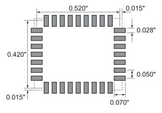
Figure 110: HUM-\*\*\*-PRO Recommended PCB Layout
