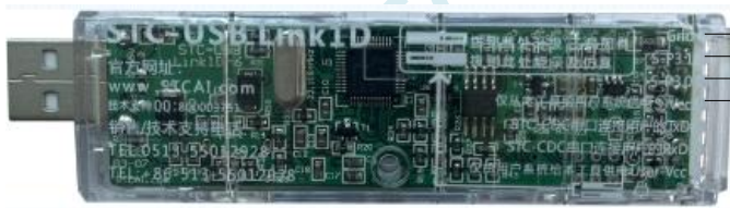
STC-USB Link1D工具: 支持全自动停电-上电在线下载 / 脱机下载 / 仿真
