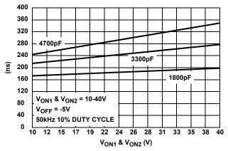
FIGURE 9. FALL TIME vs CAPACITANCE vs SUPPLY VOLTAGE WITH V<sub>OFF</sub> = -5V
