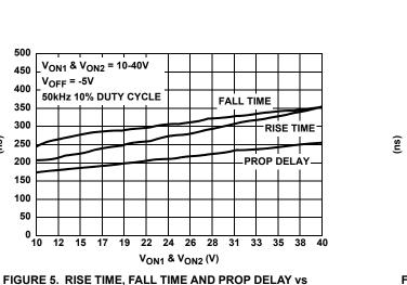
V<sub>ON1</sub> & V<sub>ON2</sub> VOLTAGE WITH V<sub>OFF</sub> = -5V
