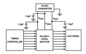
FIGURE 14. TYPICAL TV APPLICATION CIRCUIT
