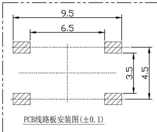
PCB线路板安装图( $\pm 0.1$ )
