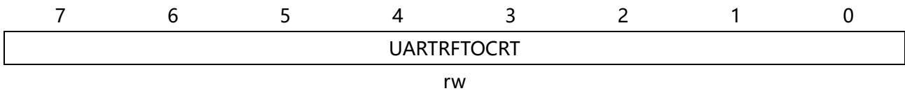
图表 11-21: UART 接收 FIFO 超时计数寄存器 2(UARTRXFTOCTR)
