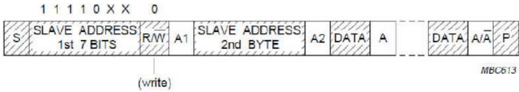
图表 13-21: 主发送器使用 10 位地址寻址从接收器
