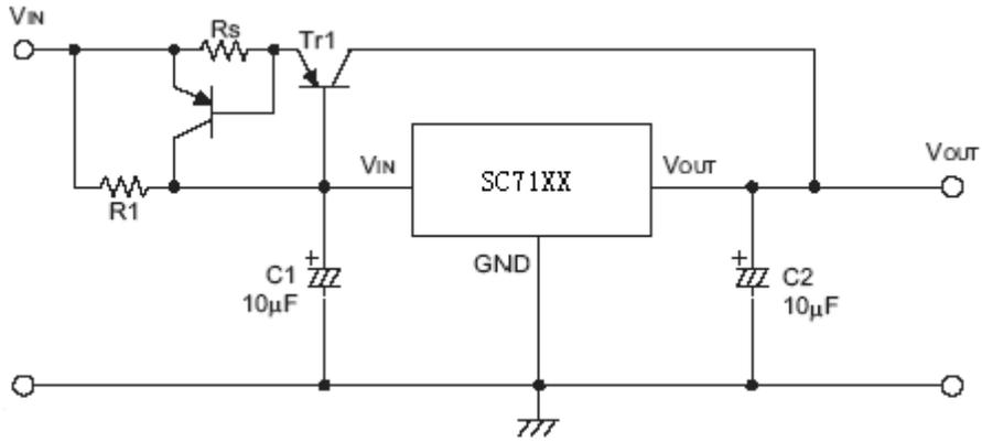
4、 提高输出电压电路(1)
