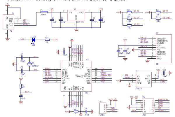
P1 是 USB 端口, USB 总线包括一对 5V 电源线和一对数据信号线,通常,+5V 电源线是红色,接 地线是黑色,D+信号线是绿色,D-信号线是白色。USB 总线提供的电源电流可以达到 500mA。
