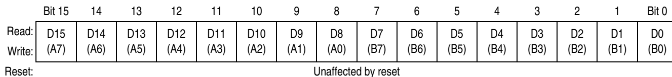
Figure 3-4. Accumulator D (D)
