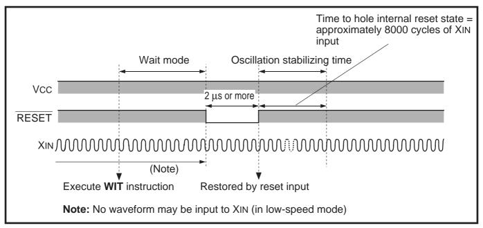
Fig. 2.8.3 Reset input time
