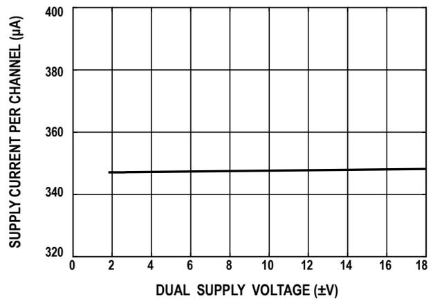
图27. 电源电流与双电源电压的关系( $V_{IN} = 0\text{ V}$ )
