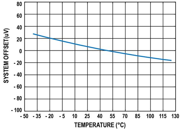
图7. 系统失调电压与温度的关系 (G = 0.5)
