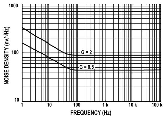
图41. 电压噪声密度与频率的关系
