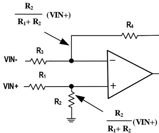
图44. 差分放大器内部的电压情况
