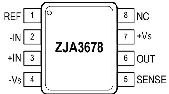
图4. ZJA3678 管脚排列图 (MSOP-8 封装)
