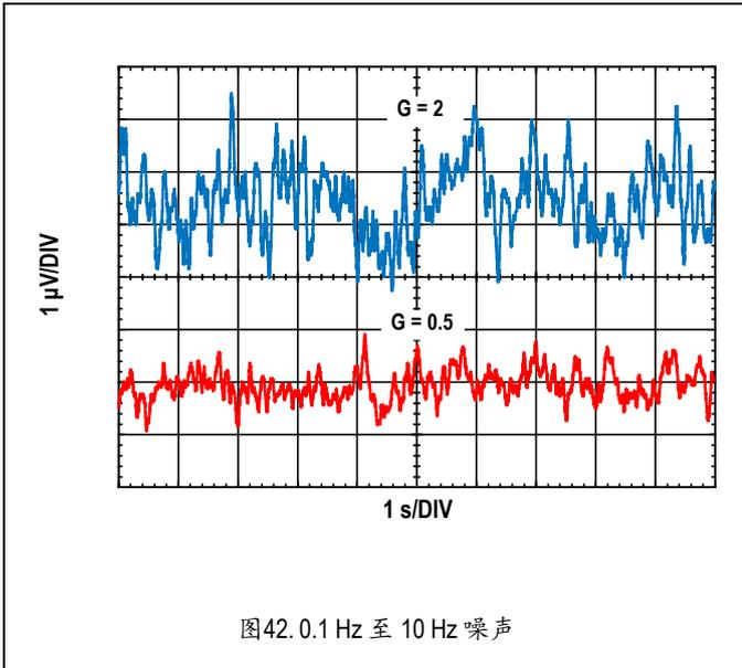
图42. 0.1 Hz 至 10 Hz 噪声
