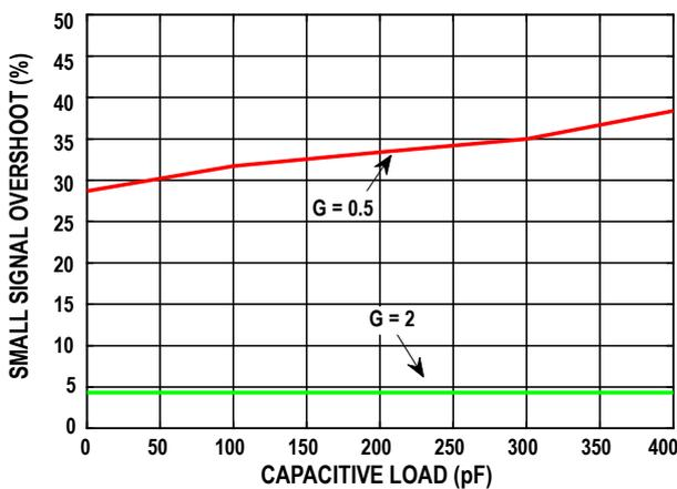
图40. 小信号过冲与负载电容的关系 ( $R_L \geq 2\text{ k}\Omega, G = 0.5\&2$ )
