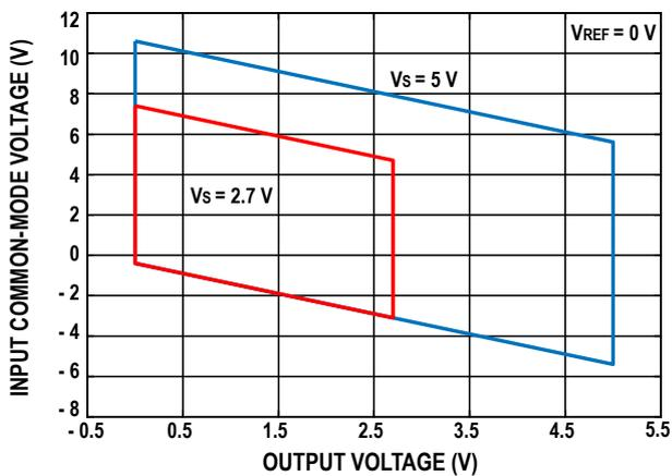
图16. 输入共模电压范围与输出电压的关系 (V<sub>REF</sub> = 0 V, G = 0.5)
