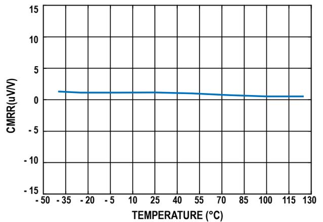
图9. 共模抑制比 CMRR 与温度的关系 (G = 0.5)
