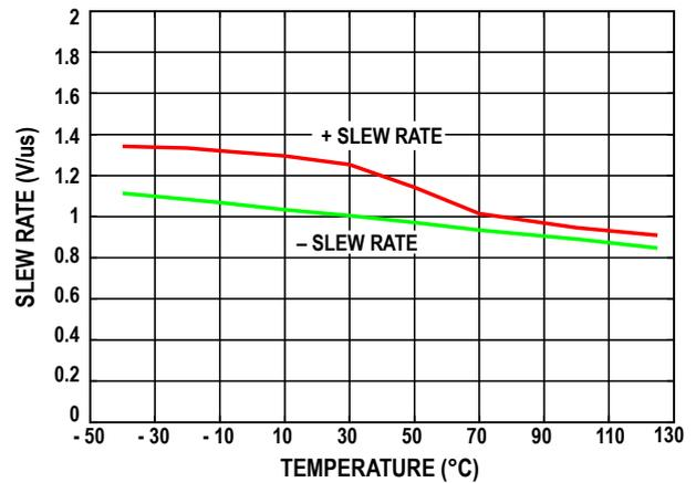
图31. 压摆率与温度的关系 (VIN = 20 Vp-p, 1 kHz)
