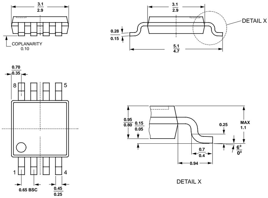
图63. MSOP-8 封装尺寸图 (单位: 毫米)
