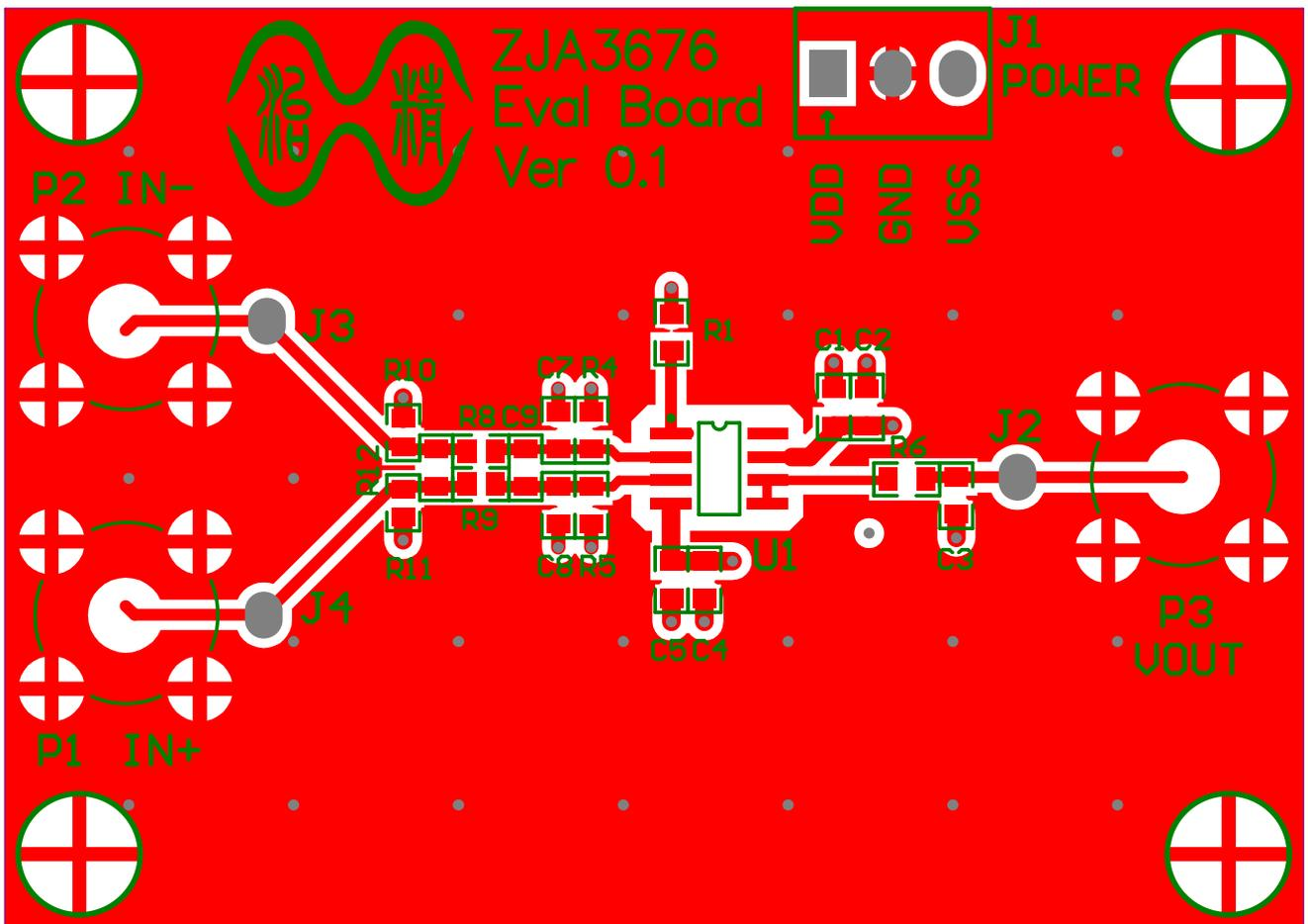
图60. ZJA3676/8 评估板 PCB 顶层设计
