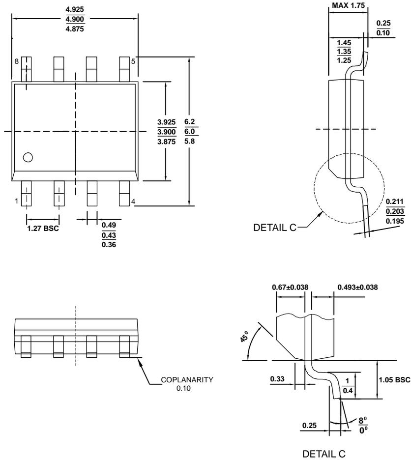
图62. SOIC-8 封装尺寸图 (单位: 毫米)
