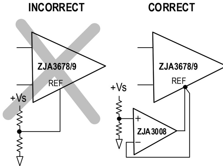
图46. REF 引脚的正确驱动方式
