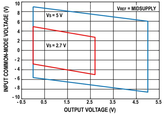
图15. 输入共模电压范围与输出电压的关系 (V<sub>REF</sub> = MIDSUPPLY, G = 0.5)
