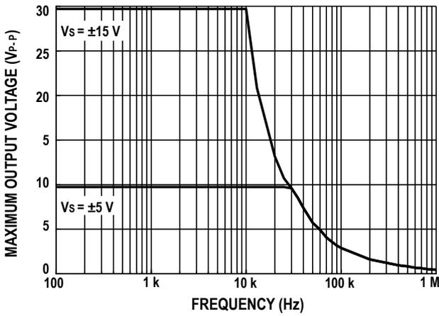
图36. 最大输出电压与频率的关系 ( $V_s = \pm 15\text{ V}, \pm 5\text{ V}$ )
