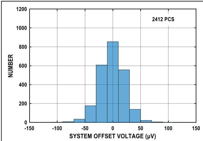
图6. 系统失调电压分布 (G = 2)
