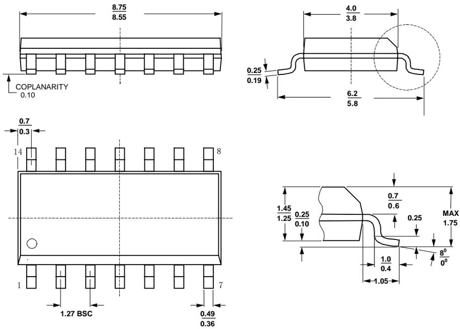
图64. SOIC-14 封装尺寸图 (单位: 毫米)
