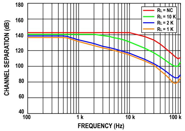
图43. 通道隔离度与频率的关系
