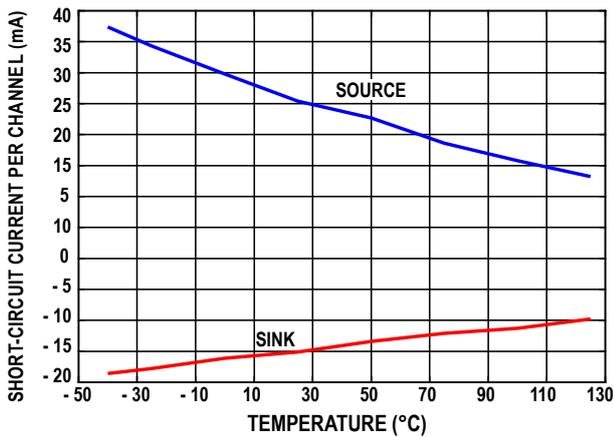
图30. 短路电流与温度的关系
