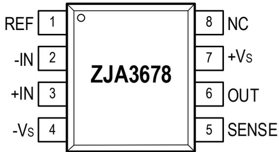
图3. ZJA3678 管脚排列图 (SOIC-8 封装)
