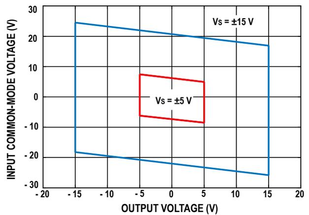
图17. 输入共模电压范围与输出电压的关系 (G = 2)
