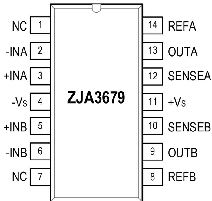
图5. ZJA3679 管脚排列图 (SOIC-14 封装)
