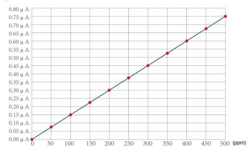
上表格测试温度与湿度: 23℃±2,50% R.H.0-500 ppm 一氧化碳传感器的输出电流。
