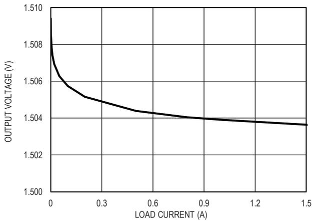
图 9. 1.5V 输出电压和负载电流的关系
