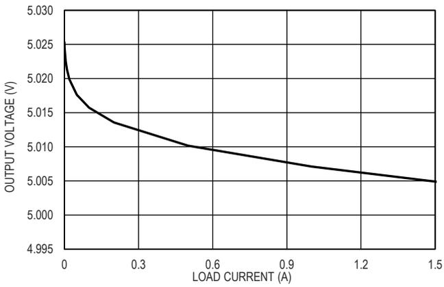
图 11. 5.0V 输出电压和负载电流的关系
