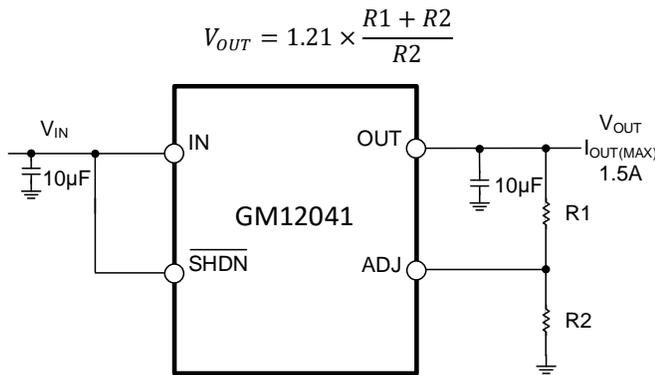
图 21. 由外部电阻决定的输出电压
