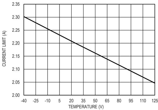
图 13. 输出限流值和温度的关系
