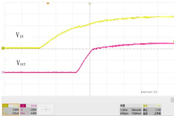
图 19. 软启动,  $V_{IN}=5.5V$ ,  $V_{OUT}=5.0V$ ,  $I_{OUT}=1.5A$
