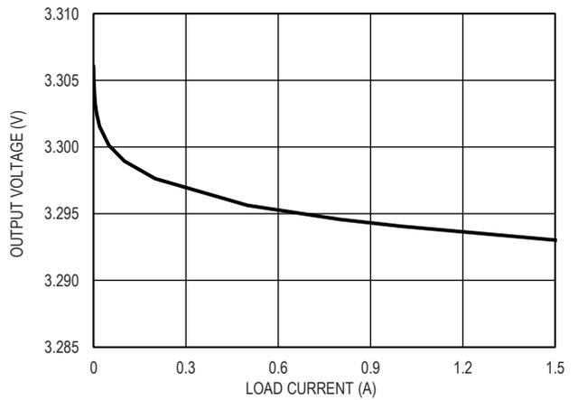
图 10. 3.3V 输出电压和负载电流的关系
