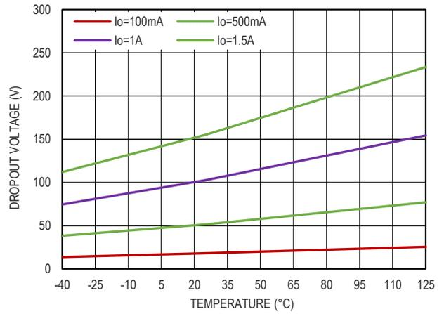
图 6. 压差电压和温度的关系
