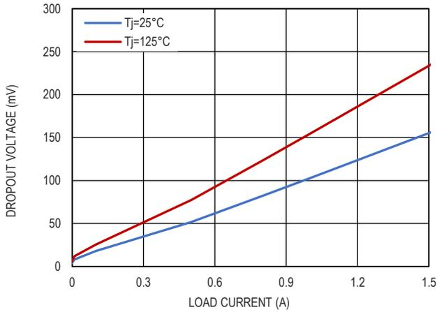
图 5. 压差电压和负载电流的关系
