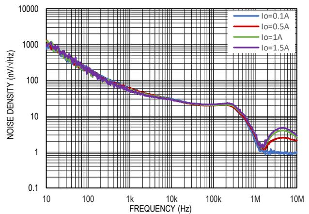
图 16. 输出噪声谱密度,  $V_{IN}=5V$ ,  $V_{OUT}=3.3V$
