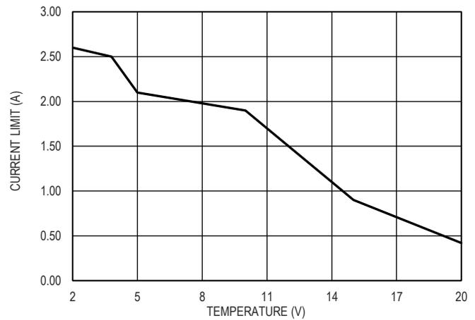
图 14. 输出限流值和输入输出压差的关系
