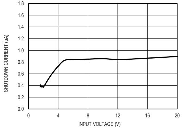
图 8. 关机电流和输入电压的关系
