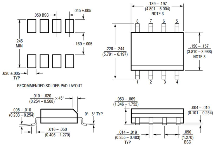
图 23. 8 引脚 SOIC-8
