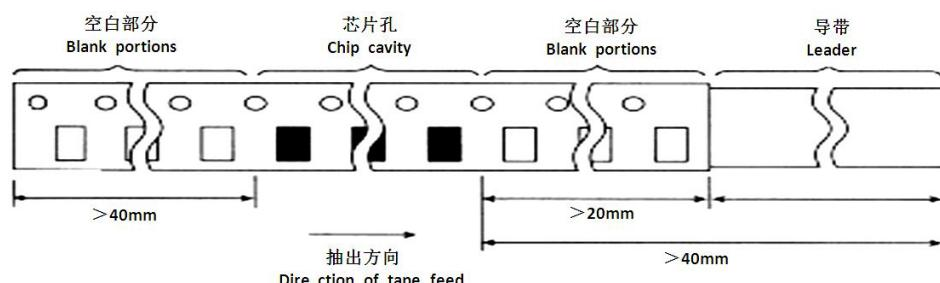
\* 编带尺寸 Taping dimensions (Unit: mm)
