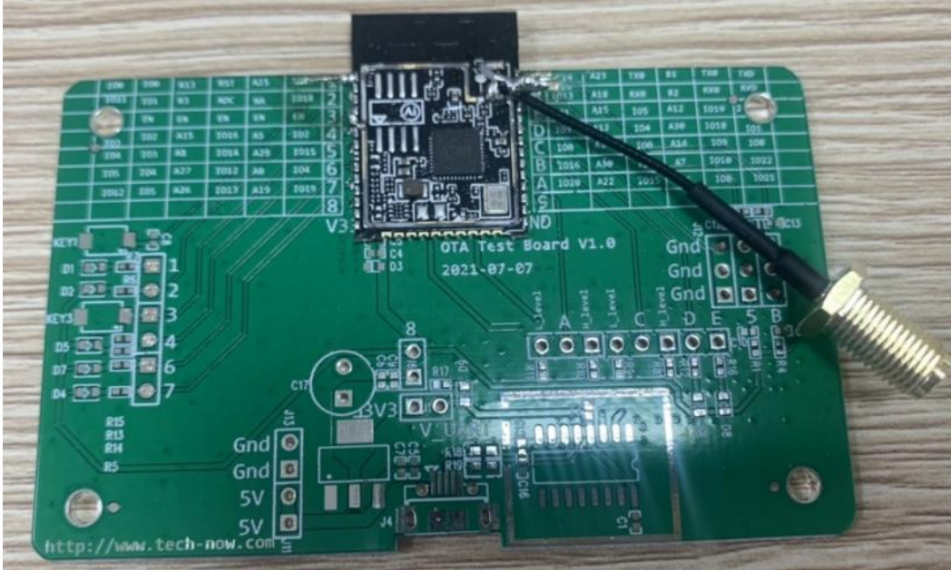
图 8 天线测试样机示意图
