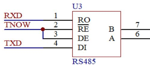
图中 TNOW 为切换引脚，用于控制 RS485 收发器的 DE（高有效发送使能）和 RE#（低有效接收使能）引脚。RS485 收发器应该与 VIO 使用同一供电电源。
