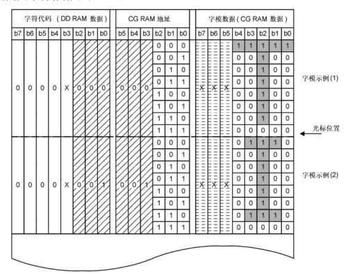
从上图可以看出自定义字符存储器 CGRAM 的地址, CGRAM 内的字模数据和自定义字符代码之间的关系。自定义字符代码与 CGRAM 地址 bit3~bit5 位的数据一致;打"X"的是无关数据;当字符代码的 bit4~bit7 位都是 0 时,字符代码对应的是自定义字符。
