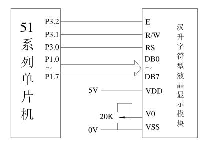
V0 是对比度调节端, Vop=Vdd-V0 即是 LCD 的驱动电压, Vop 越大, 液晶的对比度越深, 反之就浅。当 Vop 过小时, 液晶无法显示。字符型液晶的 LCD 驱动电压一般接近5V 而略低于5V,所以在使用5V 供电的字符型液晶显示模块时, V0 接近 0V 而略高于0V。
