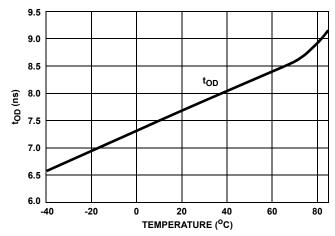
FIGURE 18. DATA OUTPUT DELAY vs TEMPERATURE
