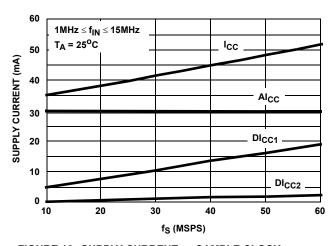
FIGURE 16. SUPPLY CURRENT VS SAMPLE CLOCK FREQUENCY
