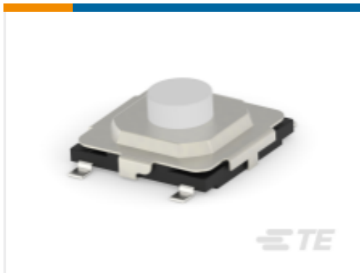
TE Part #2337238-2 TACT MINI GW 5.2X5.2X2 100GF
