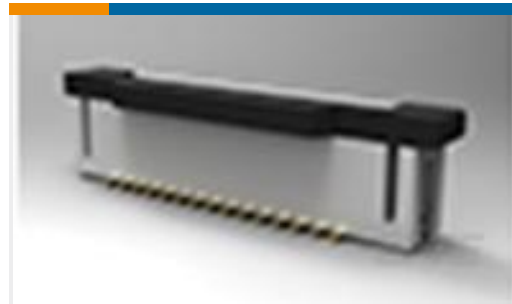
TE Part #2-1734248-0 1.0 FPC, ZIF V/T, SMT, 20P
