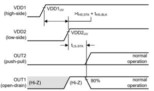
Figure 7-7. VDD1 Turns On, Followed by VDD2 (Long Delay)
