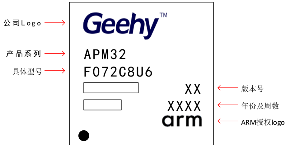
图 27 QFN48 打码规范
