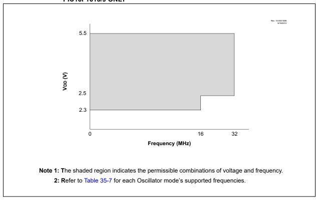
FIGURE 35-2: VOLTAGE FREQUENCY GRAPH, -40°C  $\leq$  TA  $\leq$  +125°C, PIC16LF1615/9 ONLY
