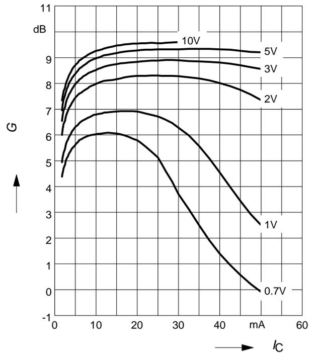
**Power Gain**  $G_{ma}, G_{ms} = f(V_{CE})$ :
