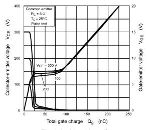
Fig. 8.6 V<sub>CE</sub>, V<sub>GE</sub> - Q<sub>g</sub>
