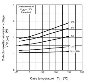
Fig. 8.4 V<sub>CE(sat)</sub> - T<sub>c</sub>
