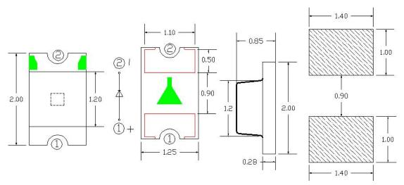
注/ Notes: 1. 单位 : 毫米 (mm) / All dimensions are in millimeters
