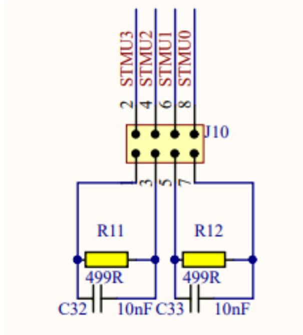
图1.4 电刺激输出接口及板上测试负载
