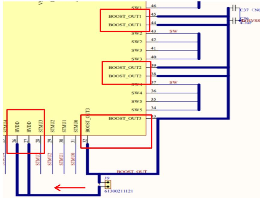
图2.4 ENS001 的boost\_out和HVDD引脚连接
