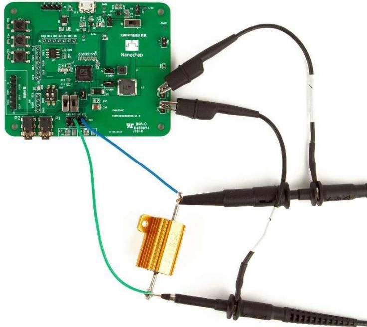
图3.12 示波器探头连接方法
