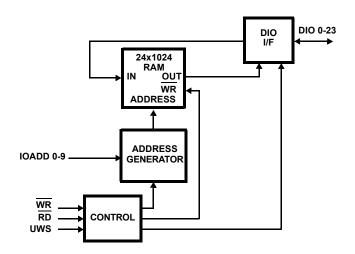
FIGURE 14. ASYNCHRONOUS 16/24 BLOCK DIAGRAM
