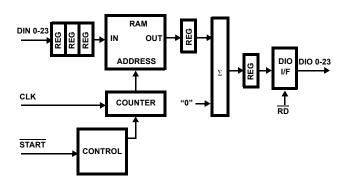
FIGURE 10. DELAY MEMORY BLOCK DIAGRAM
