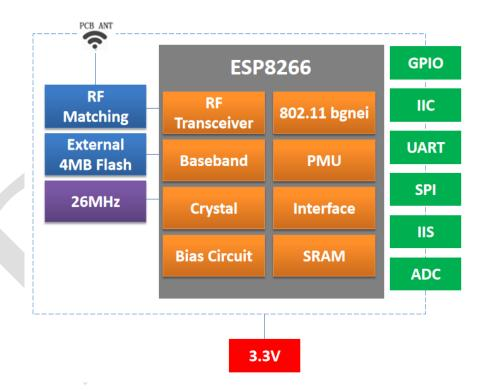
Fig. 1.1 ESP-12F Module Structure
