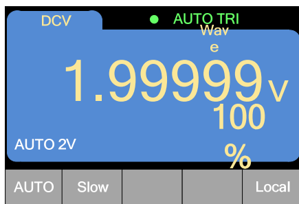
图 2.8.5 从方波输出切换到直流电压测量后的界面
