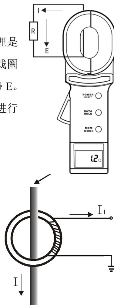
线圈产生一个感应电流  $I_1$ ，钳表对  $I_1$  进行测量，通过下面的公式即可得到被测电流  $I$ 。
