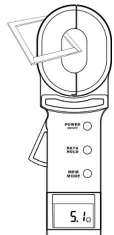
测试环上的标称值是在温度为 20℃ 下的值。显示值与标称值相差一个字，是正常的。如：测试环的标称值为 5.1 Ω 时，显示 5.0 Ω 或 5.2 Ω 都是正常的。显示“OL Ω”，表示被测电阻超出了钳表的上量限，见图 3。显示“L0.01 Ω”，表示被测电阻超出了钳表的下量限，见图 6。
