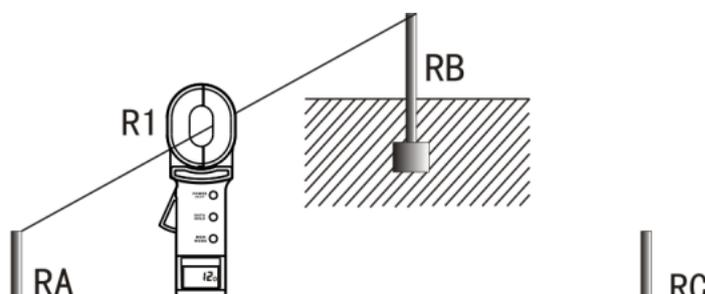
第二步，将  $R_B$  和  $R_C$  连接起来，见下图。用钳表读得第二个数据  $R_2$ 。
